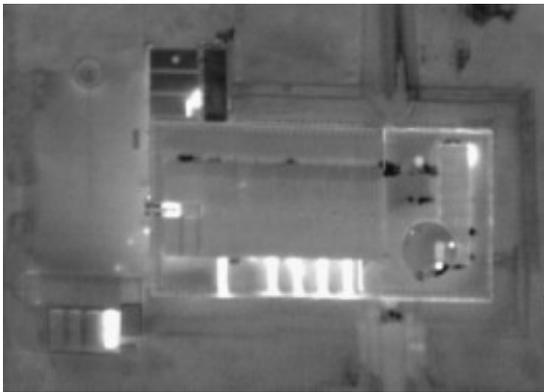
Image thermique de la toiture d'un bâtiment industriel. Emission de rayonnement "froid" invisible
