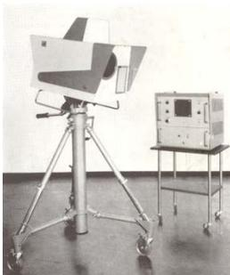
La caméra thermique est un appareil photo numérique spécial (et encore onéreux) ; il est sensible au rayonnement thermique des objets froids (dans l'infrarouge, entre 8 et 12  $\mu\text{m}$ , pour les caméras usuelles). La matrice de détection est donc spécifique (l'un des principaux fabricants mondiaux est situé près de Grenoble). La caméra intègre aussi des technologies d'appareil de métrologie.
