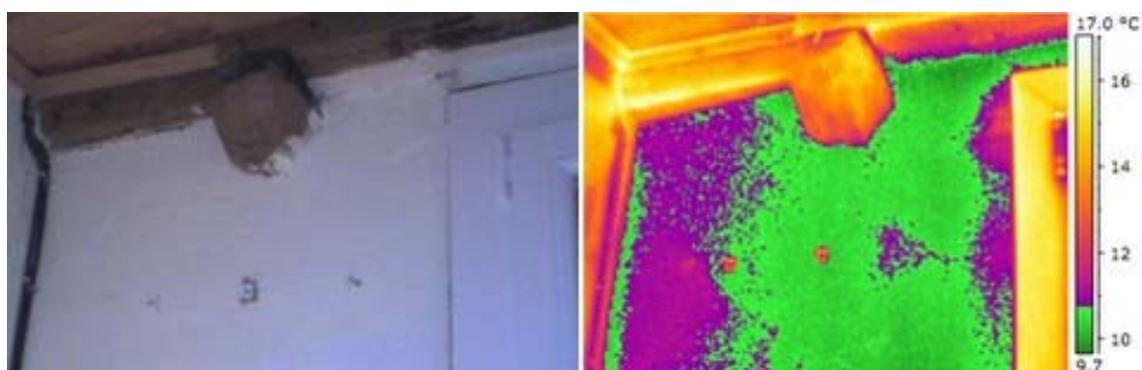
Ci-dessus : La caméra thermique détecte une zone humide (en vert sur l'image infrarouge) sous la solive, à gauche de la fenêtre.
